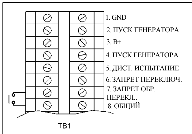
РИСУНОК 7-11. СОЕДИНЕНИЯ ТВ1 ДЛЯ ЗАПРЕТА ОБРАТНОГО ПЕРЕКЛЮЧЕНИЯ
