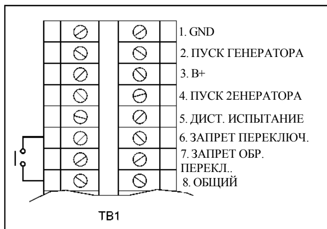
РИСУНОК 7-10. СОЕДИНЕНИЯ ТВ1 ДЛЯ ЗАПРЕТА ПЕРЕКЛЮЧЕНИЯ
